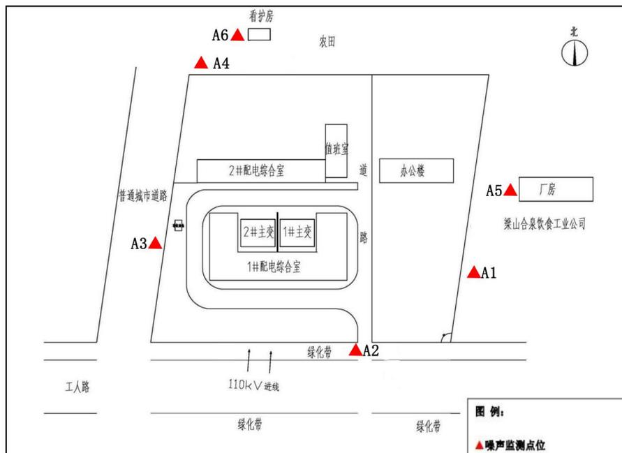
**图 7-2 变电站厂界噪声、环境敏感目标处的环境噪声检测布点图**
