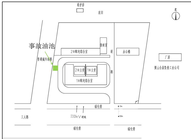
图 4-10 北关 110kV 变电站总平面布置图
