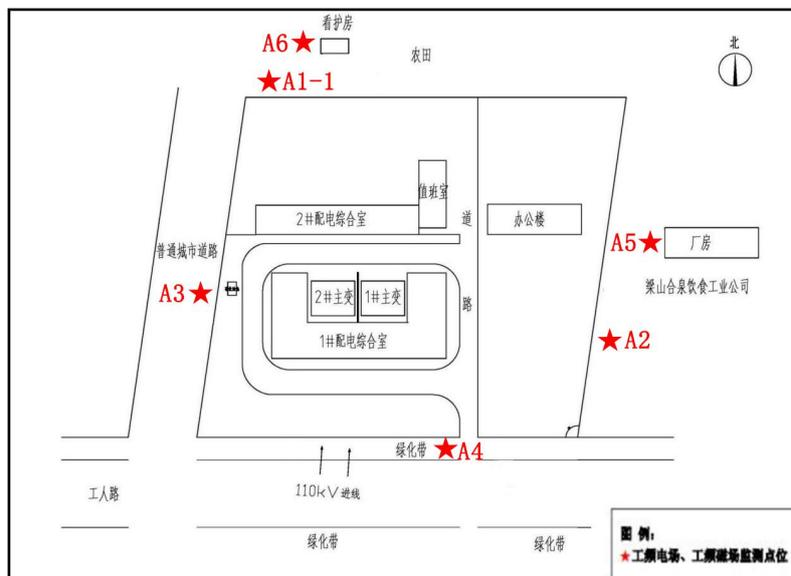
图 7-1 北关 110kV 变电站工频电场、工频磁感应强度检测布点图
