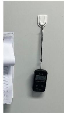
图 3-10 个人辐射剂量当量(率)报警仪
