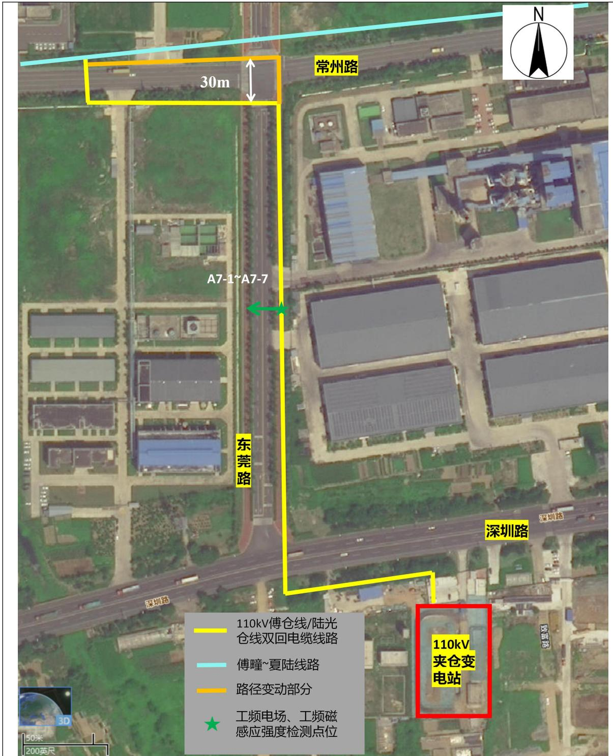
图 4-11 环评线路路径、实际线路路径图及检测布点图
